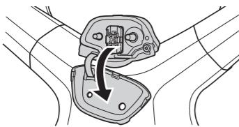
2. 如图所示，连接充电线。（连接时，充电线和充电端口形状匹配）
