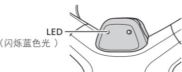
通过 ANT® 连接至自行车码表或连接至 E-TUBE PROJECT 时，一旦零位偏移校准完成，您的自行车码表或智能手机上将显示“5050”。
