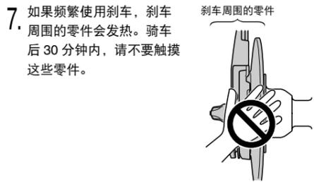
7. 如果频繁使用刹车，刹车周围的零件会发热。骑车后 30 分钟内，请不要触摸这些零件。
