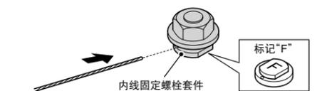
3. 请如下图所示安装零件，并拧紧内线固定螺母。关于内线固定螺母的的拧紧方法，TL-IM21 请按图 1 所示行事。拧紧后，请确认内线固定螺母和内线的朝向是否与图 2 相同。
