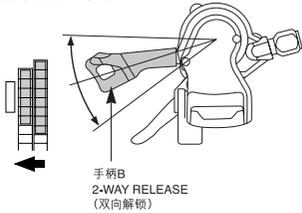
在操作B手柄时，首先在调正操作部位附近会有“咔嚓”的声音，过后一点点是变速结束行程。在调正操作之后，调正操作部位会消失，只剩下变速结束行程。
