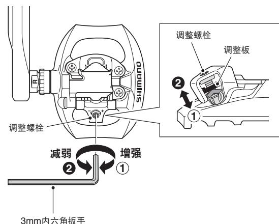
顺时针旋转调整螺栓，弹簧力度增强，逆时针旋转调整螺栓，弹簧力度减弱。
