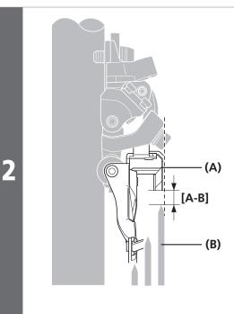
让外导板的平整部分与最大链轮片的平面
