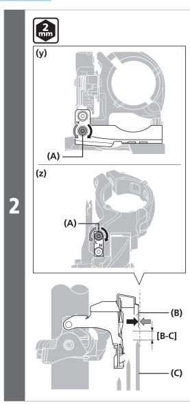
调整低速限位螺钉,并让导链器外导板的 平整部分与最大链轮片的平面平行。
