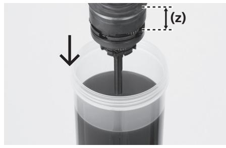
从左侧将内部单元浸入油内，直到油达到环形齿轮组件 1，如图所示。
