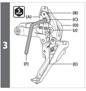
通过将转换器选择工具滑入板和外连接之间 的间隙连接它。此时,将工具上的折叠部件 插入外连接中的孔。在连接工具之后,稍微 拧紧线固定螺钉。
