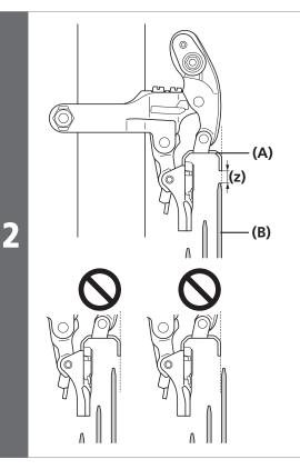
作出调整,使导链器外导板与最大链轮片之间有 1 - 3mm 的间隙。
