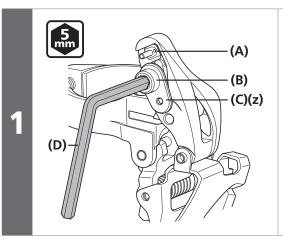
松开线固定螺钉。通过向下旋转板露出 转换器。
