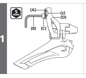
松开线固定螺钉以在板和外连接之间形成间隙。
