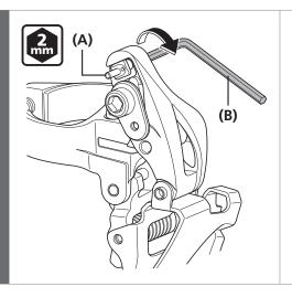
将 2mm 六角扳手插入转换器的背面并将其推出。逆时针转动转换器 180 度。
