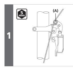
在拉紧内线的同时,用 **5mm** 六角扳手拧紧固定螺栓以便固定刹车线。
