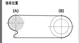
将链条设置到后方的最大飞轮片上,而在前面,将链条切换到最小牙盘上,然后再换回到最大链轮片上。
