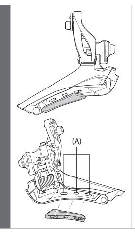
将防滑护板插入安装孔。
