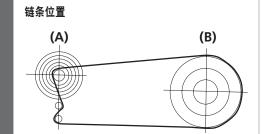
将导链器外导板与链条之间的间隙调整至 0 - 0.5mm 之间。
