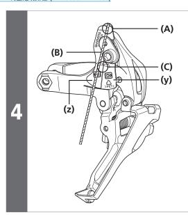
将线缆和工具上的线缆槽对齐,然后 拉动它。检查线缆是否经过中心线的转 换器开启侧或转换器关闭侧上方。 根据工具提供的指示将转换器设置为开启/ 关闭。
