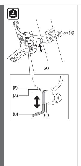
安装了前拨链器的支撑螺钉后,请检查支螺 栓与车架直接接触的位置,并将备用垫片安 装在该位置。此外,请避免将把带(用于将 备用垫片安装至座管)安装在支撑螺钉直接 接触车架的位置。
