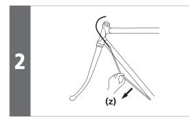
如图所示,将线的初始延伸除掉之后,重新固定至前拨链器。
