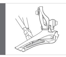
在防滑护板的图示位置上用老虎钳开一个切口,然后拆下防滑护板。
