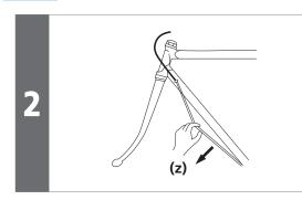
如图所示,将线的初始延伸除掉之后,重新固定至前拨链器。
