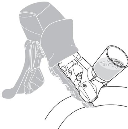
漏斗内的油中无气泡后，暂时关闭灌油螺钉。
