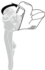
**2. 使用螺丝刀打开电池座，然后向下按压旧的纽扣电池进行拆卸。**
