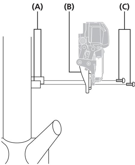
使用中轴安装固定螺钉安装前拨链器。
