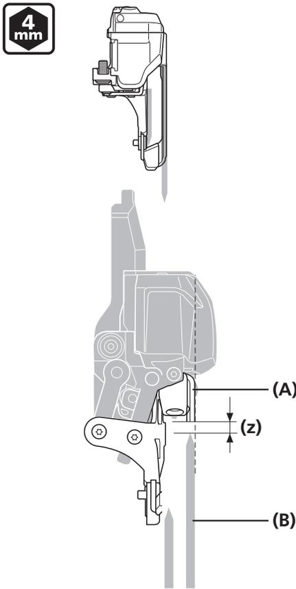
安装前拨链器，使导链器外导板的扁平部分直接位于最大链轮片上方并与其平行。
