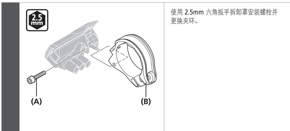
使用 2.5mm 六角扳手拆卸罩安装螺栓并更换夹环。
