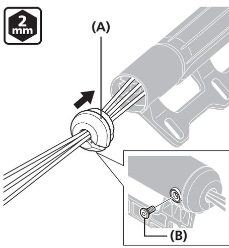
将连接到连接器安装的电线穿过盖 A 中的孔。
