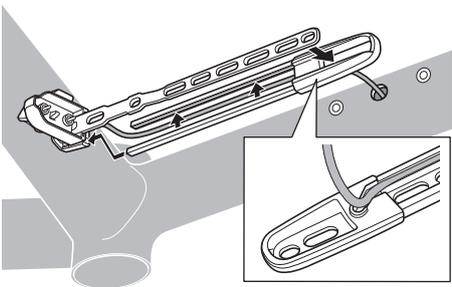
将电池安装座的电线安装在电池安装座用
