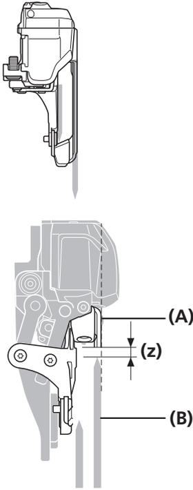
安装前拨链器，使导链器外导板的扁平部分直接位于最大链轮片上方并与其平行。
