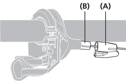
将电线穿过线盖，并将其连接到变速开关。
