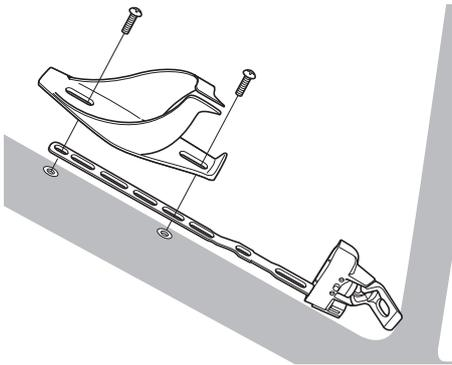
对于较长类型，使用车架或水壶架配备的螺钉进行固定。
