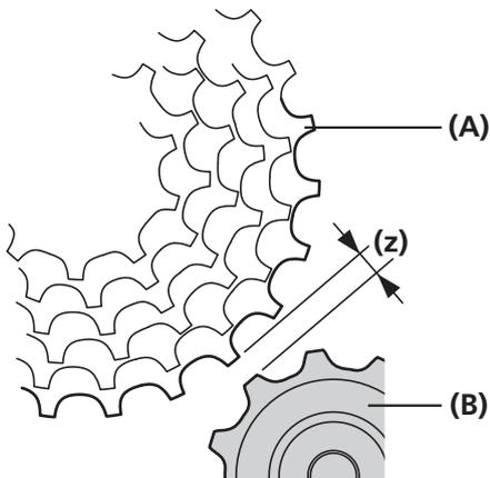
将后拨链器放置在最大飞轮片上，然后，在车轮停止的状态下，确保导向轮的尖端与最大飞轮片尖端之间的距离在(z)范围内。
