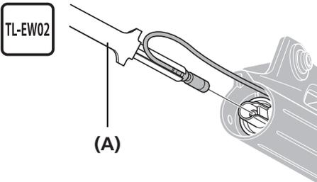
使用 Shimano 专用工具将电线连接至电池连接端子。
