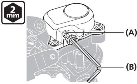
使用 2mm 六角扳手转动摩擦力调解螺栓以调整摩擦力。
