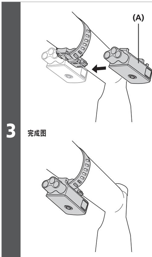
将 SM-EW90 的连接器A滑进挂钩的导轨部分以对其进行安装。
