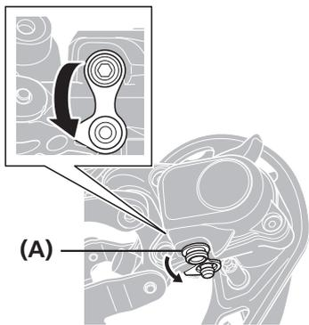
如图所示，手动取下导板组件的护盖。
