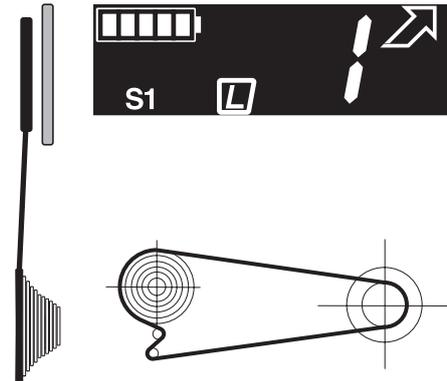
将链条调整到前最小链轮片和最大后飞轮片上。
