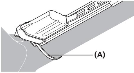
使用附带的束线带将电池座固定在车架上。
