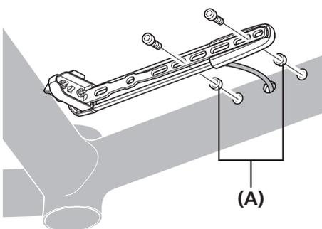
将附带的垫片夹在电池安装座和车架之间，
