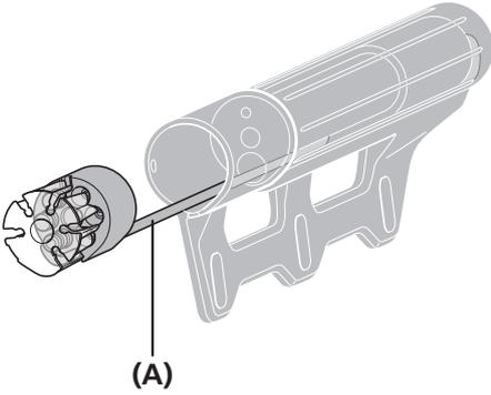
将电池连接的电线穿过电池罩内侧的孔，使线从电池罩顶部穿出。
