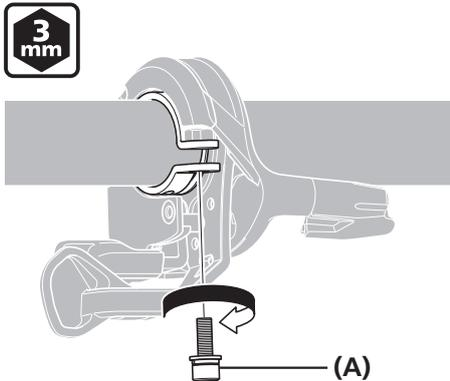
调整连接位置和角度，然后使用 3mm 六角扳手锁紧夹环螺钉。
