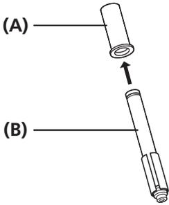
将锂离子电池（内置式规格）从座杆底部插入座杆夹。
