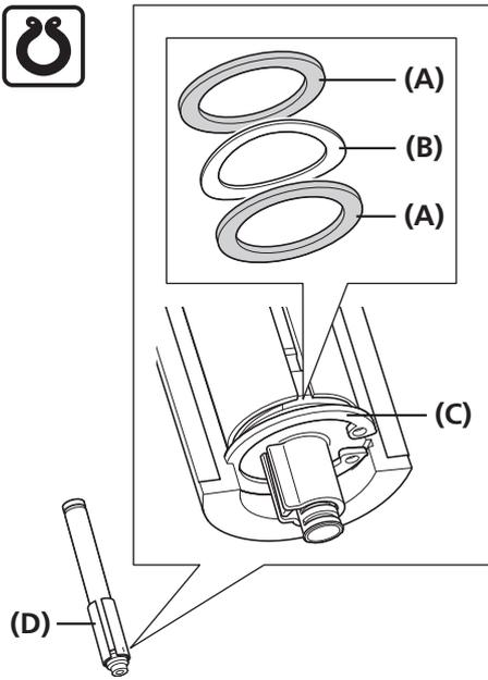
将两个垫圈之间的波形垫圈安装至电池连接器的凹槽，然后用卡环将其固定在正确位置上。
