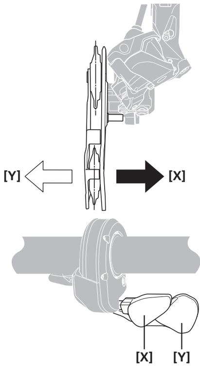
处于初始设置状态下时，若按下变速开关 [Y] 一次，导向轮将向内侧移动一段。
