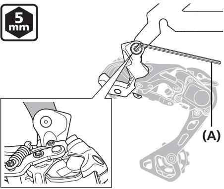
安装直接安装式后拨链器。
