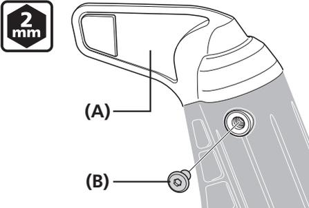
将盖 B 安装到电池罩，并使用提供的固定螺钉将其固定入位。
