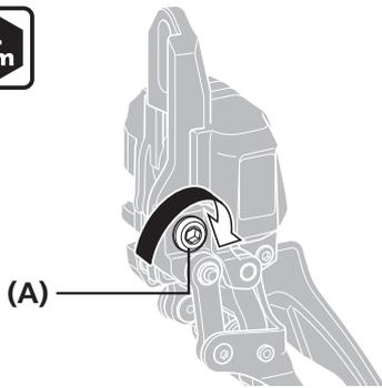
在图中指定的位置安装支架安装螺栓，然后用 4mm 六角扳手将其锁紧。
