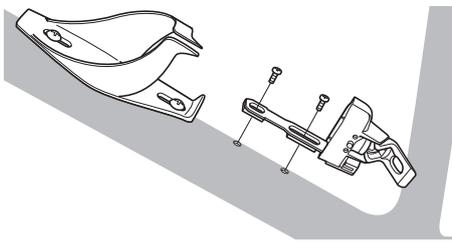
使用附带的 M4 螺钉加固较短类型。
