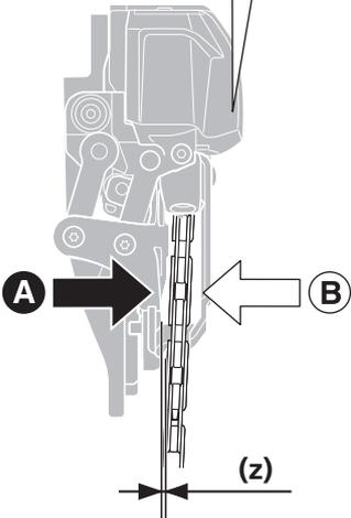
使用 2mm 六角扳手转动高速限位螺钉以调整间隙。
