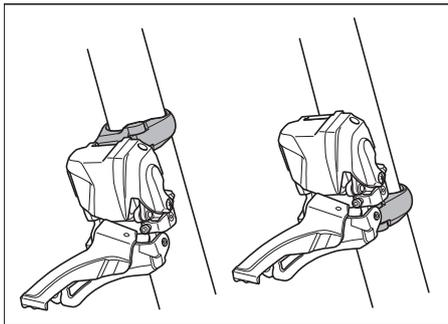
将前拨链器安装在车架上。
