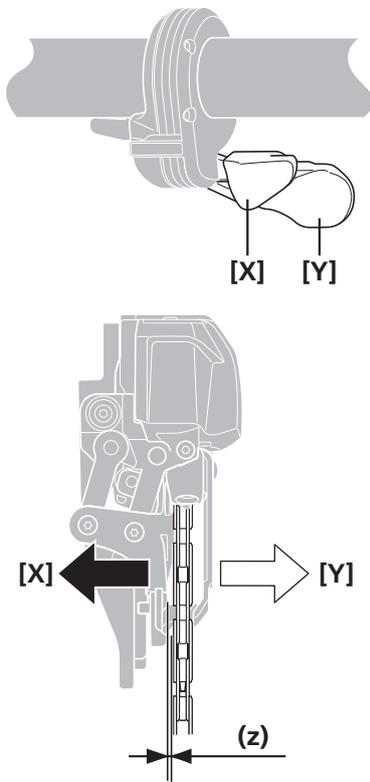
按住换挡开关的手柄，调整间隙。
