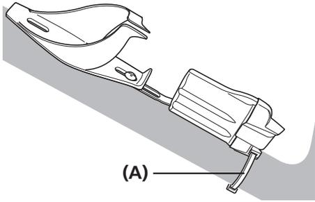
锁紧水壶架的螺钉以固定电池安装座。
