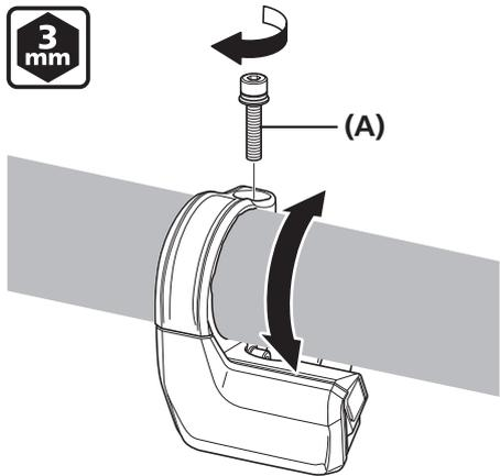
调整系统信息显示器的角度以使其方便观看，然后使用 3mm 六角扳手锁紧夹环螺钉。
