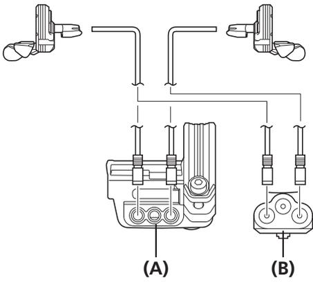
将变速开关的电线连接至系统信息显示器或连接器 A。
