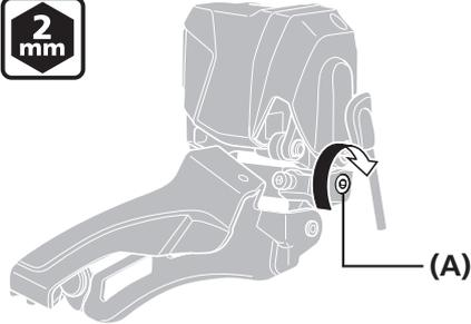
调整后，在将导链器推向车架时切实紧固行程固定螺钉。
