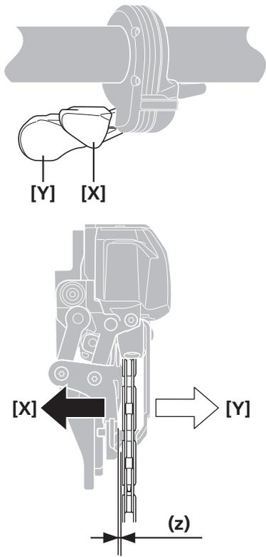
按住前侧变速开关的手柄，调整间隙。
