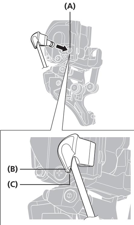
将接头盖板臂与前拨链器槽对齐，然后将电线接头推入端口部分。
