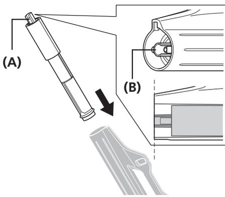
在连接端子侧朝上的状态下，从电池罩的上部插入电池。
