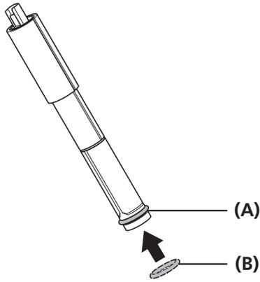
将电池罩附带的 O 形环从电池下方插入槽。
