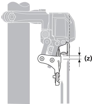
安装前拨链器，使导链器外导板的扁平部分直接位于最大链轮片上方并与其平行。
