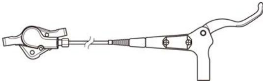
7. 推刹车油管的同时锁紧连接螺钉。
