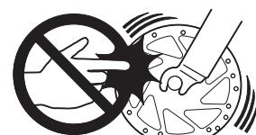
• 骑行时或者下车之后短时间内不得触碰夹器或碟刹盘片。操作刹车时，夹器和碟刹盘片温度很高，直接接触可能引起烫伤。
