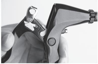
适用于卡钳刹车 / 悬臂刹车 / 罗拉刹车
