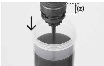
从左侧将内部单元浸入油内，直到油达到环形齿轮组件1，如图所示。
