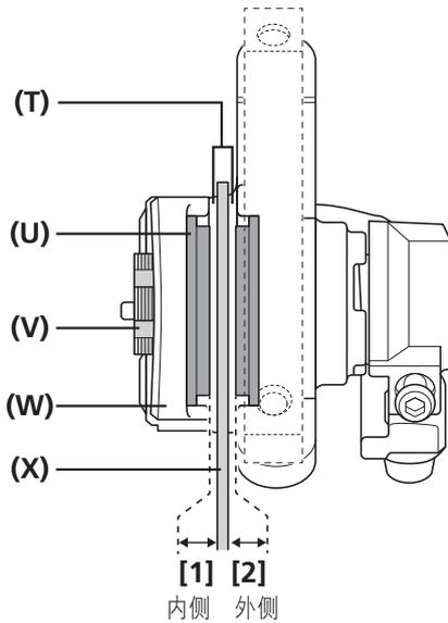
调整碟刹盘片和刹车夹板之间的两个间隙，从而它们在以下范围之内并相同：内侧 [1] = 外侧 [2]。
