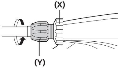
逆时针转动内线调节螺母以调整刹车线的宽松度，然后，如果提供了刹车线张力调节螺母，请将其手动拧紧。
