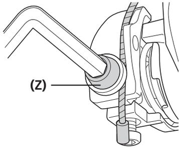
松开刹车线装配螺栓，上紧刹车线，然后再次拧紧刹车线装配螺栓。
