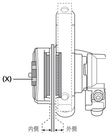
调整碟盘片和刹车夹板之间的间隙使其相等：内侧 = 外侧。
