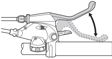
压下刹车手柄大约 10 次，直到它接触到转把套，然后检查所有零部件是否有问题，以及车轮旋转时碟刹盘片和刹车夹板是否会互相碰撞。
