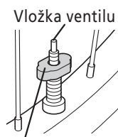
Nástroj na vybratie vložky ventilu
