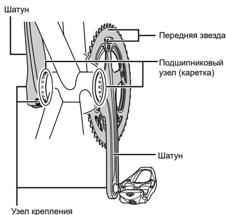
Модели с осью на узле левого шатуна
