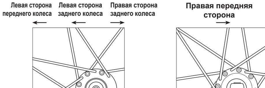
**2. Установите ротор дискового тормоза на втулку, а затем закрепите его с помощью стопорного кольца ротора дискового тормоза.**
