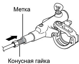
**4. Затяните конусную гайку, нажимая на тормозной шланг.**
