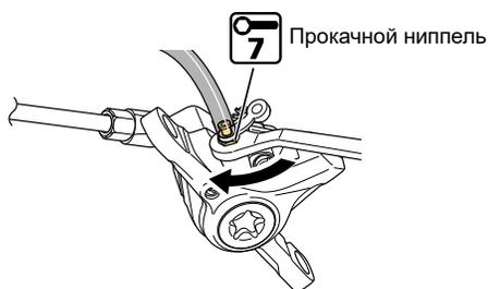
9. При нажатой тормозной ручке быстро отпускайте и затягивайте прокачной ниппель.
