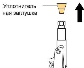
**4. Вставьте тормозной шланг в порт соединения тормозного шланга.**
