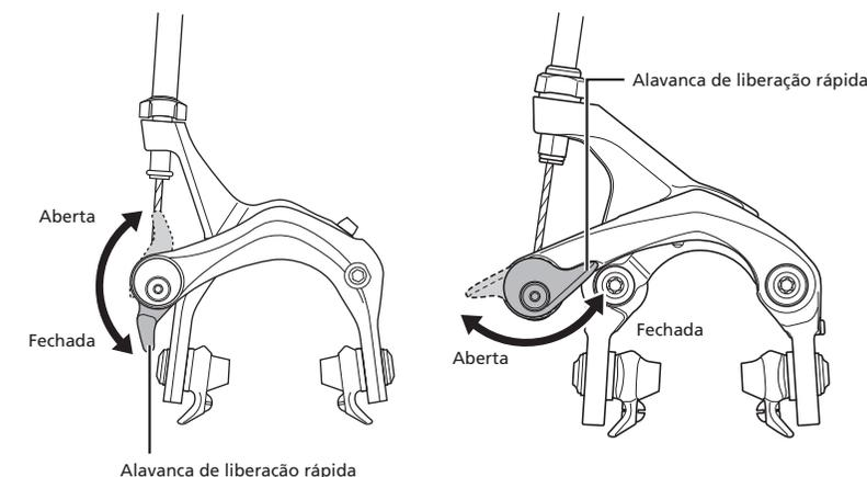
Em modelos com marca de posição FECHADA no lado da alavanca de liberação rápida e da pinça de freio, alinhe as marcas. Nesse momento, verifique se escuta um clique.
