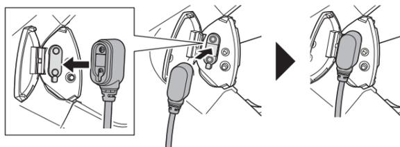
3. Depois que o carregamento começa, as luzes LED acendem com a cor azul. (Não mova o pedivela nem o cabo durante o carregamento. Há risco de desconexão do cabo. Reconecte o cabo se este ficar solto.)
