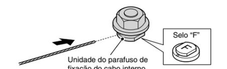
3. Coloque os componentes como ilustrados na figura a seguir, e aperte a porca de fixação do cabo interno. Use o TL-IM21 (acessório de fixação do cabo interno) para apertar a porca de fixação do cabo interno como mostrado na Fig. 1. Após apertar, verifique se as orientações da porca de fixação do cabo interno e do cabo interno estão corretas, como mostrado na Fig. 2.
