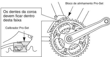
O nível da placa guia da seção da corrente deve ficar diretamente acima e paralelo ao anel de corrente maior. Fixe utilizando chave Allen de 5 mm.
