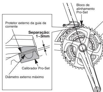
Ajuste a altura do câmbio dianteiro. A seção plana do protetor externo da guia da corrente deve estar diretamente acima e paralelo à coroa maior. Fixe utilizando chave Allen de 5 mm.
