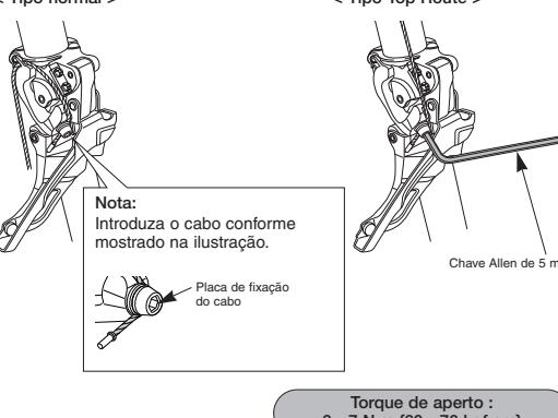
Depois de eliminar a folga inicial do cabo, fixe-o novamente ao câmbio dianteiro conforme ilustrado no desenho.
