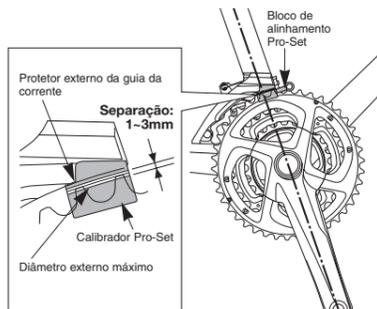
Ajuste a altura do câmbio dianteiro. A seção plana do protetor externo da guia da corrente deve estar diretamente acima e paralelo à coroa maior. Fixe utilizando chave Allen de 5 mm.
