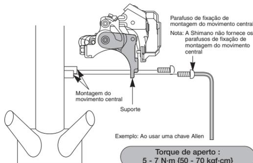
Nota: A Shimano não fornece os parafusos de fixação de montagem do movimento central.
