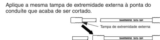
Aplique a mesma tampa de extremidade externa à ponta do conduíte que acaba de ser cortado.
