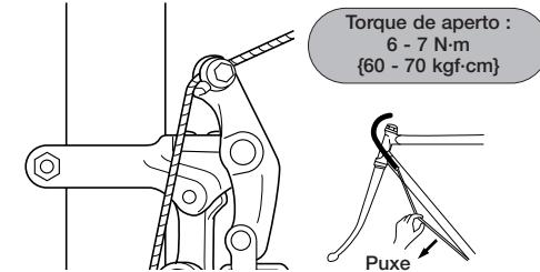
Depois de eliminar a folga inicial do cabo, fixe-o novamente ao câmbio dianteiro conforme ilustrado no desenho.
