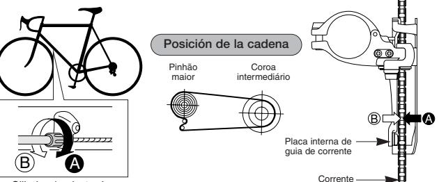
O AJUSTE é possível na alavanca de controle dual (com ajustador do cabo). Para os detalhes do método de ajuste, consulte as Instruções de Serviço para a ST-4600.
