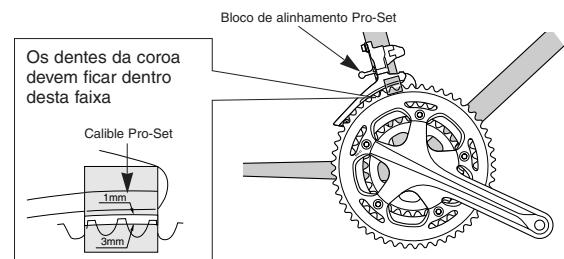
O nível da placa guia da seção da corrente deve ficar diretamente acima e paralelo ao anel de corrente maior. Fixe utilizando chave Allen de 5 mm.
