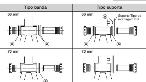
\* Usar uma carcaça do suporte tipo banda, com uma largura de 68mm, um espaçador de 1,8 mm e outro de 0,7 mm podem ser usados ao invés de um espaçador de 2,5 mm.
