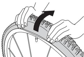
Encha com ar para travar as talas dos pneus dentro do aro conforme mostra a ilustração.
