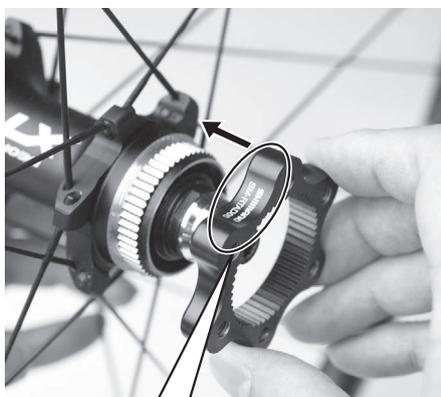
Coloque o adaptador do rotor do freio a disco no cubo.
