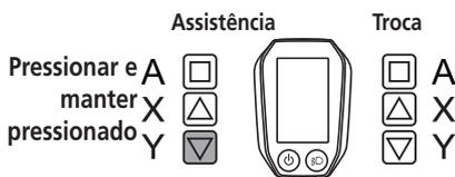
Quando [WALK] (CAMINHAR) aparecer, mantenha Assistência-Y pressionado no botão de assistência para iniciar a função de assistência na caminhada. Assistência-Y encerra a função de assistência na caminhada; pressionar Assistência-X também encerra a função de assistência na caminhada.
