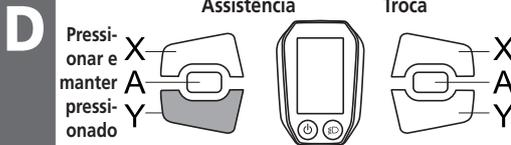
Quando [WALK] (CAMINHAR) for exibido, pressione e mantenha pressionado Assistência-Y no botão de assistência para iniciar a função de assistência na caminhada. Assistência-Y interrompe a função de assistência na caminhada, ou pressionar Assistência-X pode interromper a função de assistência na caminhada.
