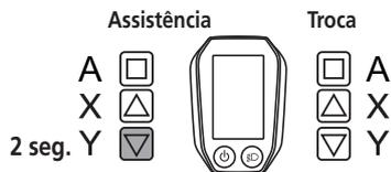
Quando o indicador de velocidade estiver indicando "0", basta pressionar o botão Assistência-Y por 2 segundos para alternar para o modo de assistência na caminhada. Pressione Assistência-X para colocar o modo em [OFF] (DESL).
