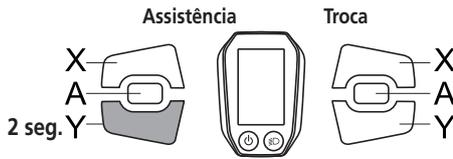
Quando o indicador de velocidade for "0", pressionar o botão Assistência-Y por 2 segundos alterna para o modo de assistência na caminhada. Pressione Assistência-X para colocar o modo em [OFF] (DESL).
