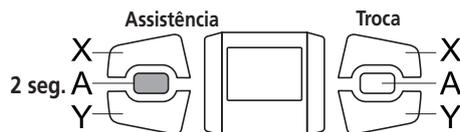
Quando a iluminação está configurada no E-TUBE PROJECT, pressionar o botão Assistência-A por 2 segundos exibe essa informação ao invés do relógio e do modo de assistência. O farol liga e desliga toda vez que a indicação for exibida. A indicação é exibida por cerca de 2 segundos.
