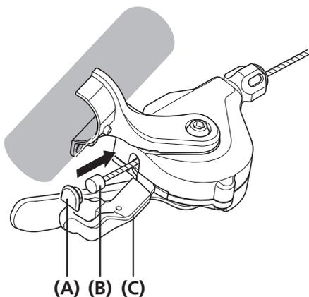
Opere (C), mostrado na ilustração, de modo a colocar a corrente na menor coroa de todas/menor pinhão de todos e, em seguida, encaixe o cabo interno. Em seguida, remova o terminal de fixação do terminal do fio e instale o cabo.
