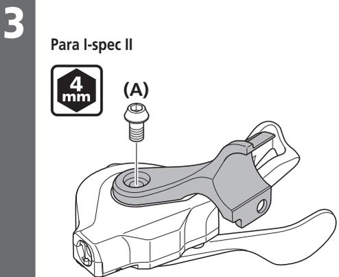
Remova o parafuso de fixação da unidade.
