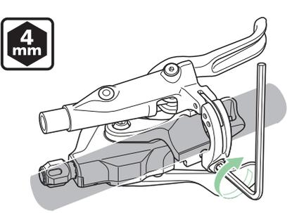
Fixe a faixa de fixação do manete de freio com uma chave Allen.
