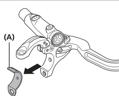
Remova o adaptador encaixado no interior da faixa de fixação. Remova qualquer fita adesiva restante.
