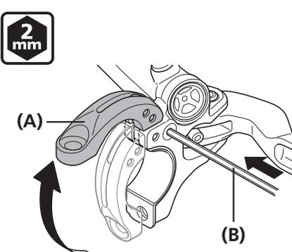
Use uma chave Allen para abrir a faixa de fixação do manete de freio, como mostrado na ilustração.
