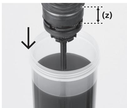
Mergulhe a unidade interna no óleo a partir do lado esquerdo até que o óleo chegue à unidade do anel de mudança 1, conforme a figura.
