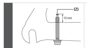
Insira os parafusos de montagem C da pinça de freio na área de montagem do quadro, e verifique se o comprimento da parte saliente de cada parafuso de montagem C da pinça de freio é de 13 mm. (Z) Parafuso de montagem C da pinça de freio
