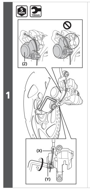
Introduza o cabo interior; em seguida, com o braço na posição inicial, aperte o parafuso de fixação do cabo. (X) Cabo interior
