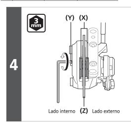
Desaperte o parafuso de ajuste da pastilha, girando-o no sentido antihorário, um ou dois cliques.
