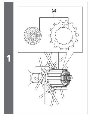
Ao ajustar os pinhões, ajuste cada um para que a superfície com a marca de grupo fique voltada para fora, de modo que a área com a ranhura larga no corpo da roda livre fique alinhada com a área da ranhura larga da seção convexa em cada pinhão.
