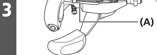
Remova o indicador e depois puxe o cabo interior e prossiga instalando o novo cabo.
