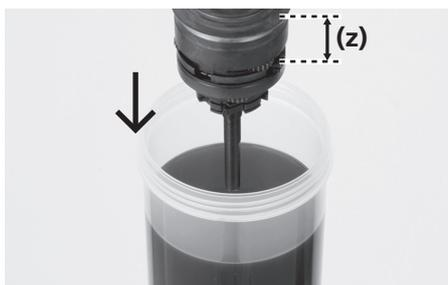
Mergulhe a unidade interna no óleo a partir do lado esquerdo até que o óleo chegue à unidade da engrenagem anular 1, conforme a figura.
