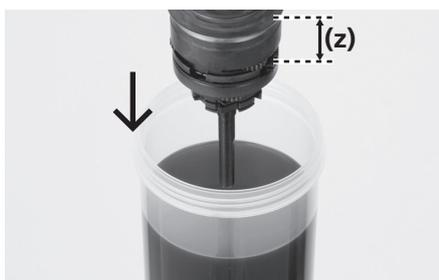
Mergulhe a unidade interna no óleo a partir do lado esquerdo até que o óleo chegue à unidade da engrenagem de anel 1, conforme a figura.
