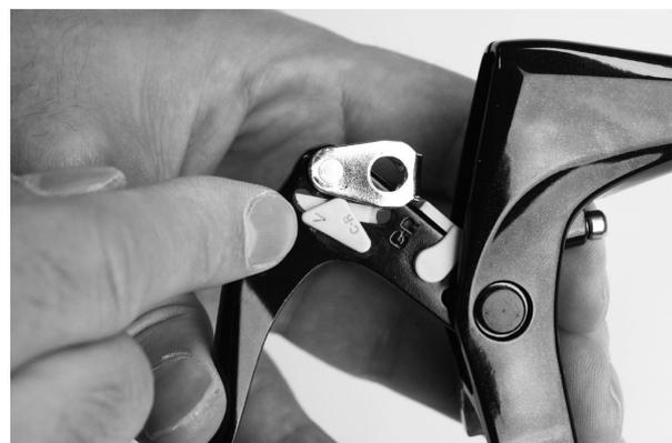
2. Alinhe o interruptor de modo com a posição do travão instalado.
