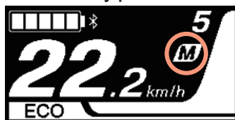
Przykład wyświetlacza w trybie ręcznej zmiany przełożeń
