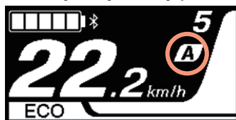
Przykład wyświetlacza w trybie automatycznej zmiany przełożeń
