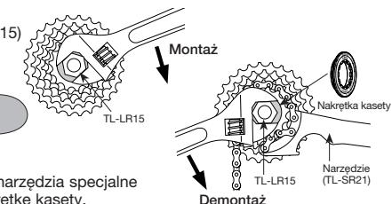
Aby wymienić koronki HG zastosować narzędzia specjalne (TL-LR15) i TL-SR21, aby odkręcić nakrętkę kasety.
