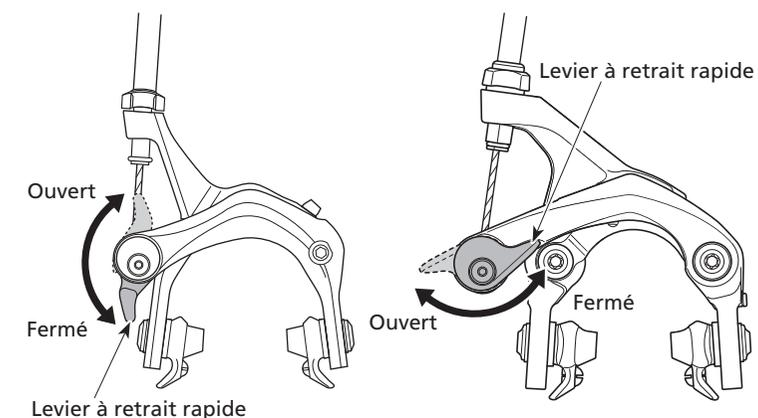
Pour les modèles avec le repère de position FERMER sur le levier à blocage rapide et le côté de corps de frein, réglez la position de chaque repère afin que ces derniers soient alignés. À ce stade, vérifiez si vous entendez un clic.
