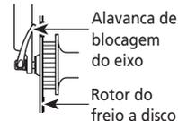
Se a alavanca de liberação do eixo não for usado corretamente, a roda poderá soltar-se da bicicleta, podendo causar ferimentos graves.
