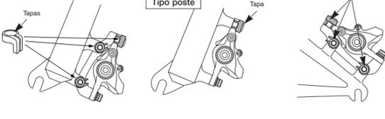
Para guías con forma C y el tipo normal de tope de cable, use el soporte de cable especial de Shimano (en venta por separado) para asegurar de la manera indicada en la figura.
