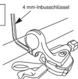
Die Schalthebelposition kann durch seitliches Verschieben eingestellt werden.
