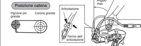
Collegare il cavetto interno al cambio di velocità come mostrato in illustrazione.
