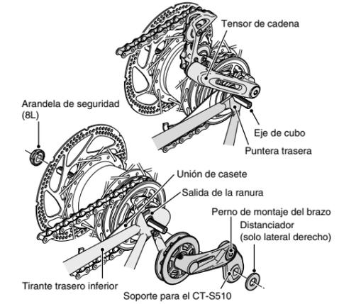
2. Coloque las arandelas de seguridad en los lados derecho e izquierdo del eje del buje. En este momento, gire la unión de casete de manera que las partes salientes de las arandelas de seguridad encajen en las ranuras de las salidas y la unión del casete pase por el interior de la vaina.
