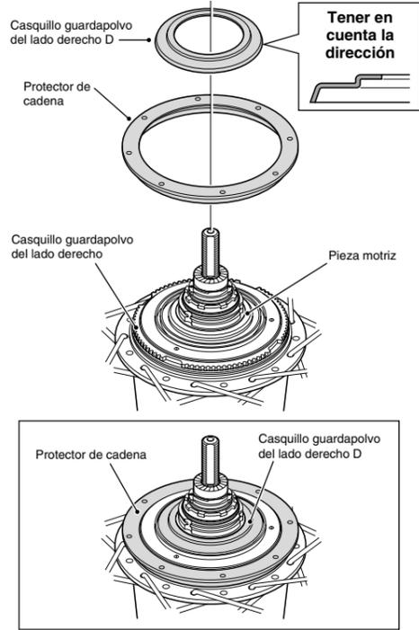
2. Instale la rueda dentada CS-S500 en la pieza motriz del lado derecho del cuerpo del cubo con la placa de protección mirando hacia fuera, y asegúrela en el lugar con la arandela de retención.
