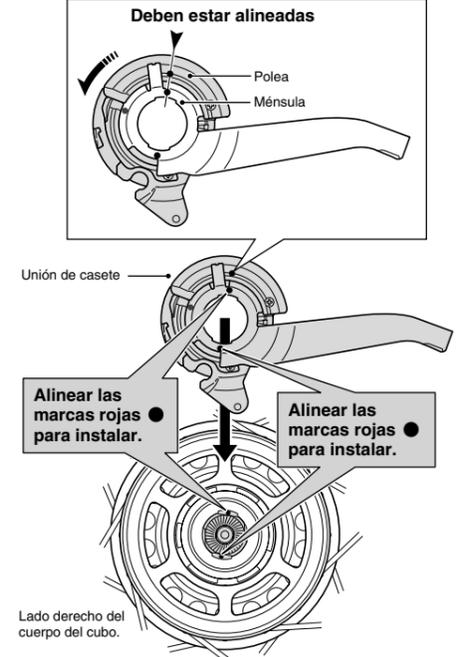
3. Asegurar la unión de casete al cubo con un anillo de fijación de unión de casete. Al instalar el anillo de fijación de unión de casete, alinear la marca amarilla ● con la marca amarilla ● de la polea de unión de casete, y luego girar el anillo de fijación de unión de casete 45° hacia la derecha.
