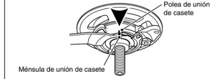
Si las líneas de ajuste amarillas no están alineadas, girar el perno de ajuste del cable de la palanca de cambio para alinear las líneas de ajuste. Después, mover la palanca de cambio una vez más de [6] a [11] y luego de nuevo a [6], y luego volver a verificar que líneas de ajuste amarillas están alineadas.
