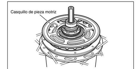
2. Girar la polea de unión de casete en la dirección de la flecha en la figura para alinear las marcas rojas ● en la polea y la ménsula. Con la unión de casete en estas condiciones, instálela de manera que la marca roja ● en la unión de casete esté alineada con la marca roja ● del lado derecho del cuerpo del cubo.
