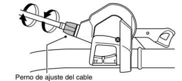
2. Después de ajustar la unión de casete, cortar el exceso de cable e instalar el casquillo de extremo de cable. Tras colocar el extremo interior de la tapa, doble el cable interior hacia afuera (hacia el extremo del bastidor) para prevenir que entre en contacto con la cadena.
