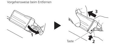
Öffnen Sie die Klemme, drücken Sie die Taste und ziehen am Akku, um ihn zu entfernen.
