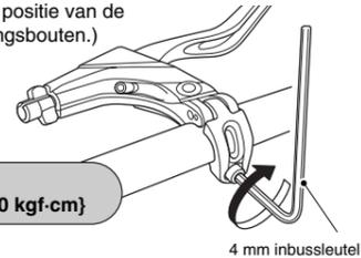
Controleer in het geval van het monteren van onderdelen aan een koolstof frame/stuurdelen de aanbeveling van de fabrikant van het koolstof frame/delen omtrent het aantrekkoppel om beschadiging van het koolstof materiaal door een te hoog aantrekkoppel en/of het losraken van onderdelen als gevolg van een te laag aantrekkoppel te voorkomen.
