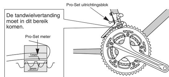
Het platte gedeelte van de buitenste plaat van de kettinggeleider dient direct boven en parallel ten opzichte van de grootste kettingring te staan.
