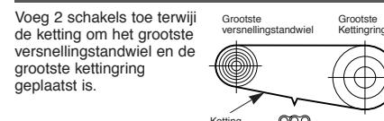
**Afstelling van het schakelbereik en bevestigen van de kabel****1. Afstelling van de hoogste versnelling**
