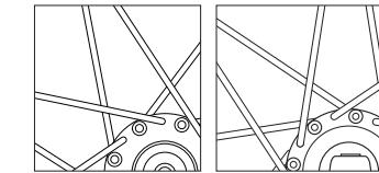
Controleer of de spaken zijn ingeregen zoals aangegeven in de illustratie. Radialmontage mag niet worden toegepast.
